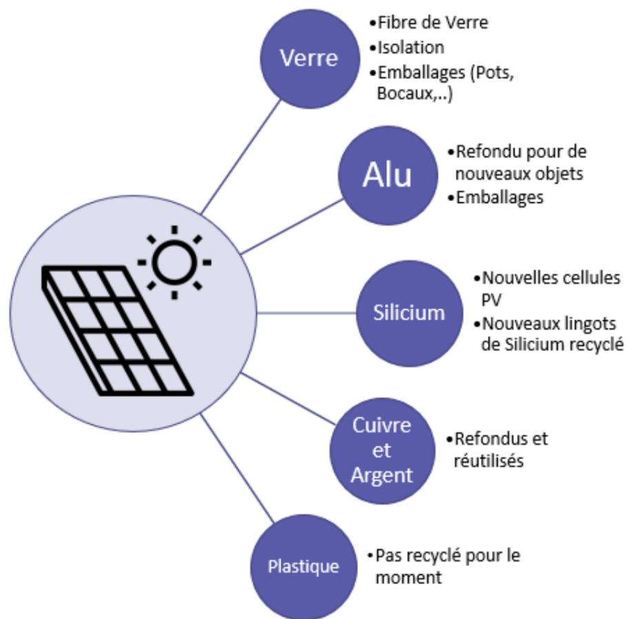
**Figure 37 : Composants d'un module**
