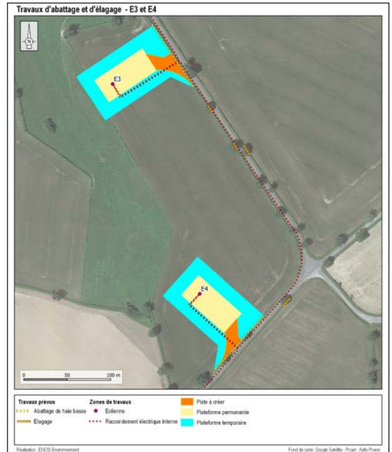
Carte 61 : Secteurs de coupe de haies, d'élagage et de décapage d'habitats (E3 et E4)
