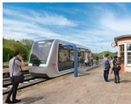
Draisie, un petit train léger complémentaire des TER pouvant embarquer 80 passagers à 100km/h développé par la SNCF
